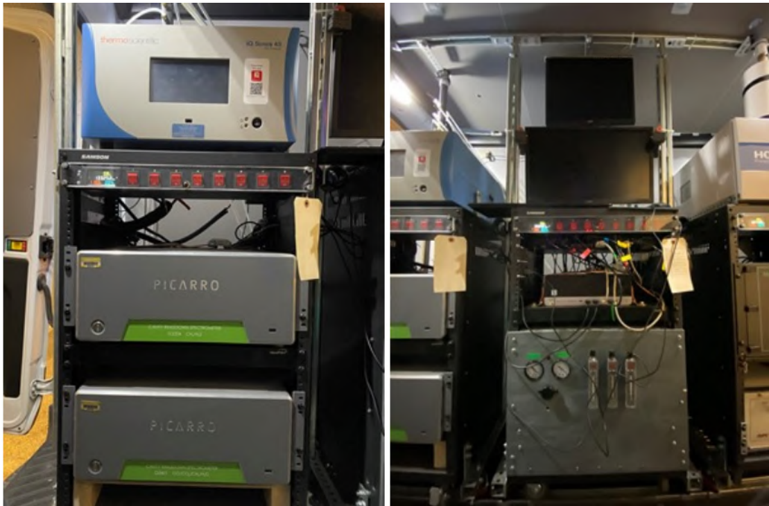
(左图)从上到下:Thermo Scientific 43iQ、Picarro G2204、Picarro G2401。(右图)从上到下: Picarro 和 Horiba 显示器, PC 显示器, 带串行通信集线器的桌面工作站, 泵箱
