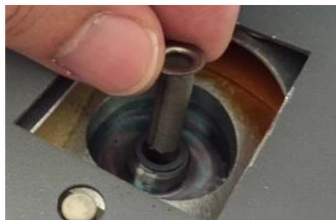
化器（右图）中。当注入溶解性总固体(TDS)高的水样在汽化器室内汽化时，衬管网格能够捕获高达 80%的盐沉淀物。这显著减少了汽化器中盐的积聚，从而将海水分析的运行时间延长到 24 小时。这种插件可在几分钟内拆除、清洁和重新安装。
